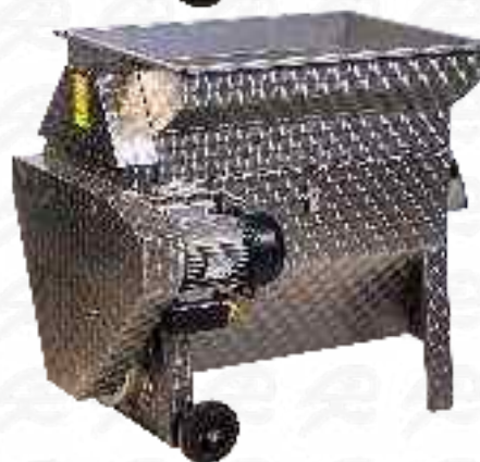
13060025 (MOD. K20) INOXIDABLE ESTRUJADOR 220V. INOX. Tolva: 600x850mm. Abatible Peso: 92Kg. Bomba Inox. Motor 2-2,5CV Producción: 1500Kg/H. Aprox.
